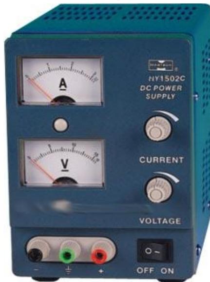
Лабораторный блок питания Mastech HY1502C обеспечивает питание электронных устройств и схем постоянным напряжением в диапазоне от 0 до 15 Вольт и током в диапазоне от 0 до 2 Ампер. Регулировка параметров осуществляется потенциометрами. Выходные значения тока и напряжения контролируются на стрелочных амперметре и вольтметре. Погрешность измерений составляет не более 2,5 %.
