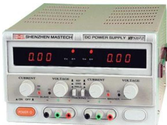
Один из самых мощных блоков питания Mastech модель Mastech NY5002-2 является двухканальным источником постоянного тока для питания электрических и электронных устройств и схем с помощью двух независимых каналов напряжением от 0 до 50 Вольт и током нагрузки от 0 до 2 Ампер каждый. При необходимости каналы соединяются последовательно или параллельно для удвоения выходного напряжения или тока соответственно.
