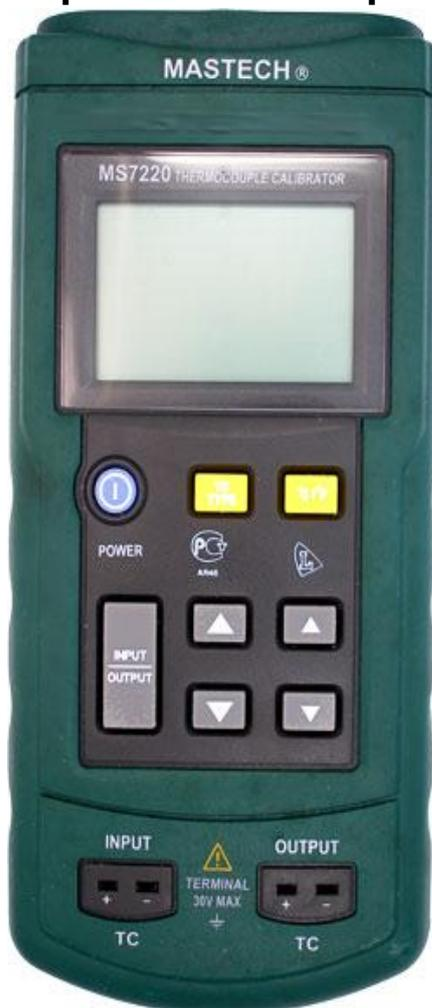
Калибратор термопар MS7220 является высокоточным источником и измерителем и предназначен для калибровки термоизмеряющих инструментов и приборов через термостабилизированный мини разъем. Показания на дисплее Калибратора термопар MS7220 могут отображаться в °C, °F, или мВ. Измеряемая температура выдается с термостабилизированного выхода Калибратор позволяет работать с восемью типами термопар и оснащен линейным термостабилизированным передатчиком.
