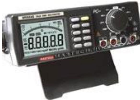
Стационарные мультиметры Mastech, или как их еще называют, настольные мультиметры, предназначены главным образом для лабораторий, сервисных центров, мастерских по ремонту. Они рассчитаны на длительную непрерывную работу, обладают высокой точностью, в них применены много разрядные индикаторы. Стационарные цифровые мультиметры Mastech с удовольствием используют инженеры сервис-центров ведущих производителей электроники и бытовой техники.
